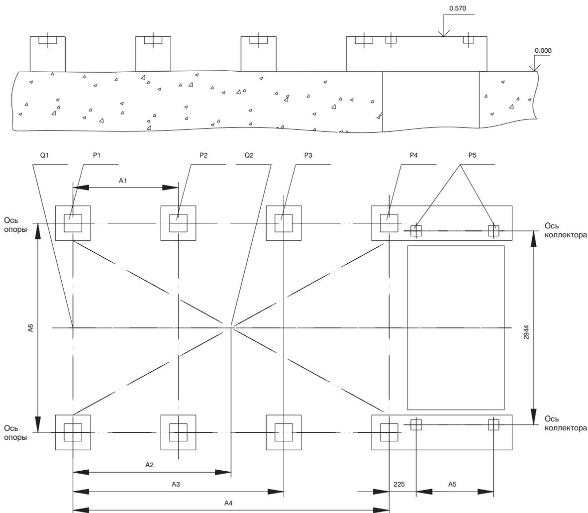
1. Буквой "P" обозначены сосредоточенные нагрузки, буквой "Q" - равномерно распределенные нагрузки.
