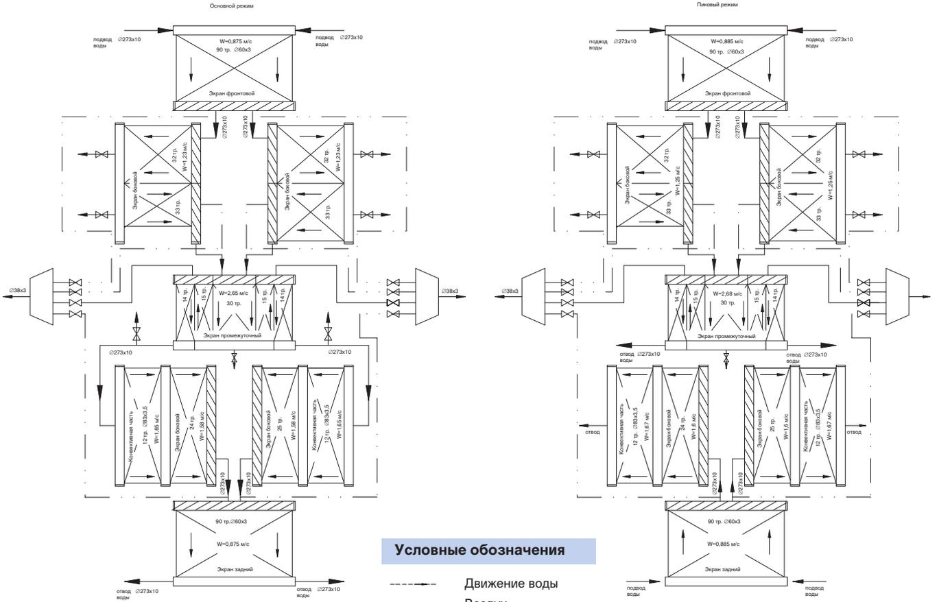
Схема гидравлическая принципиальная котла KB-ГМ-116,3-150
