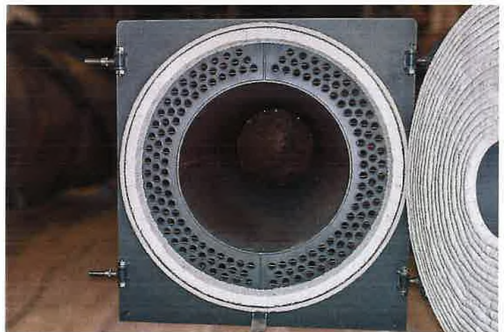
Рис.4 Вид на топку и дымогарные трубы
