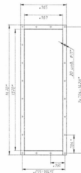
А (1:10) ВЫХОД ДЫМОВЫХ ГАЗОВ
